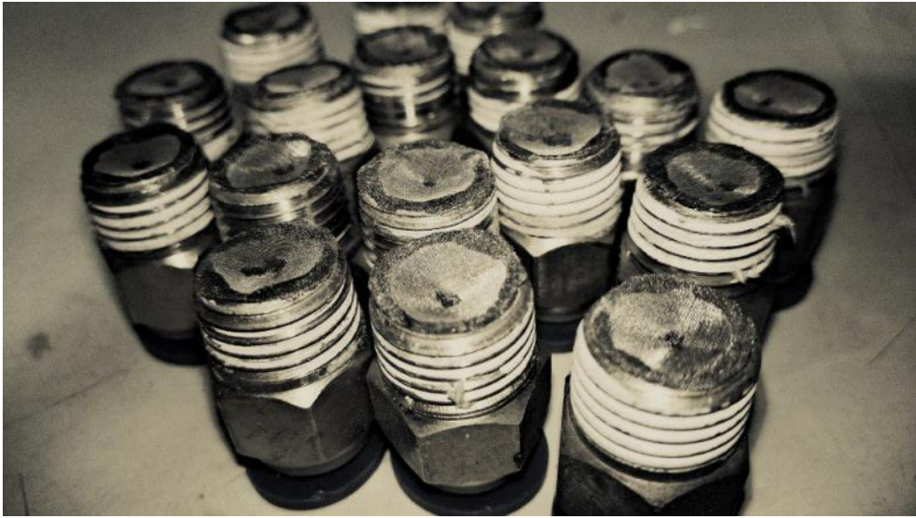
รูปที่ 3.6 ตะแกรงกรองอนุภาคที่เกิดลิวทงเหลือง
