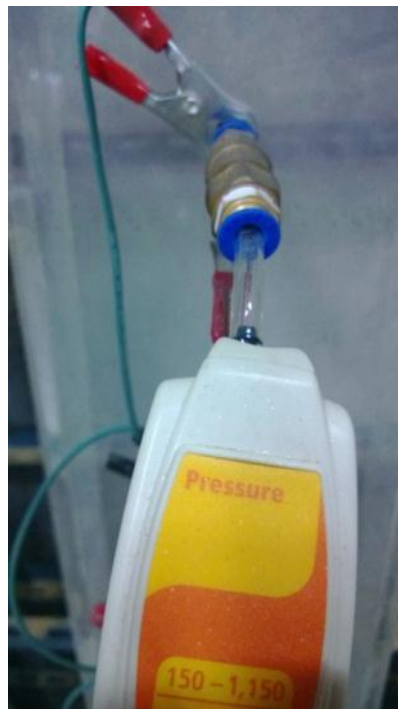
รูปที่ 3.7 การป้อนไฟฟ้ากระแสตรงเข้าที่ข้อต่อของเหลือง
