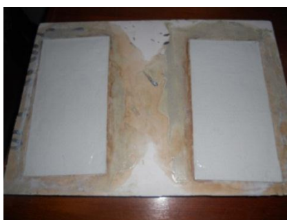
ภาพที่ 3.18 น้ำยางธรรมชาติพรีวัลคาไนซ์และน้ำยางสังเคราะห์เอสบีอาร์ ในแท่นพิมพ์
