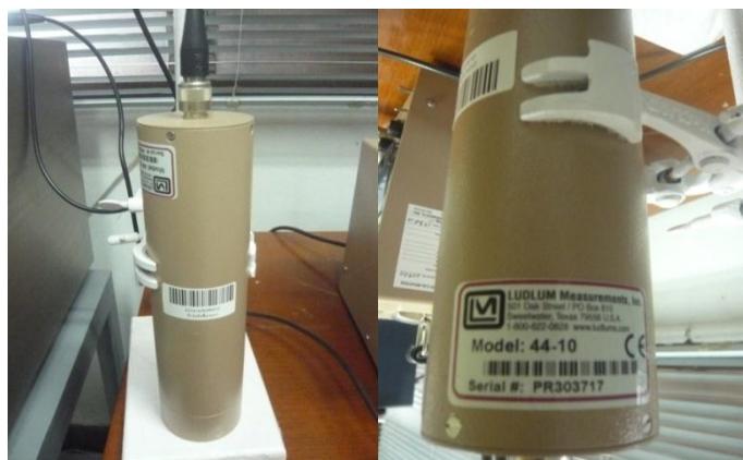
ภาพที่ 3.5 หัววัดรังสีแกมมา Ludlum Model 44-10 Gamma Scintillator (Sodium iodide (NaI))
