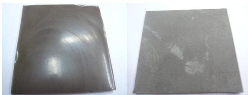
ภาพที่ 3.30 สารละลายบิสมีทกับน้ำยางธรรมชาติพรีวัลคาไนซ์ และน้ำยางสังเคราะห์เอสปีอาร์ ที่ผสมเสร็จแล้ว
