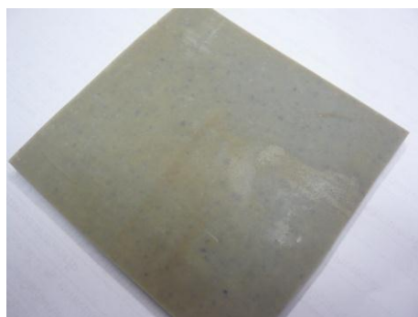
ภาพที่ 3.25 แผ่นบิสมีทแบงผง ผสมกับน้ำยางธรรมชาติพีวีแอลไนด์ และน้ำยางสังเคราะห์เอสปีอาร์ทีที่แห้งแล้ว
