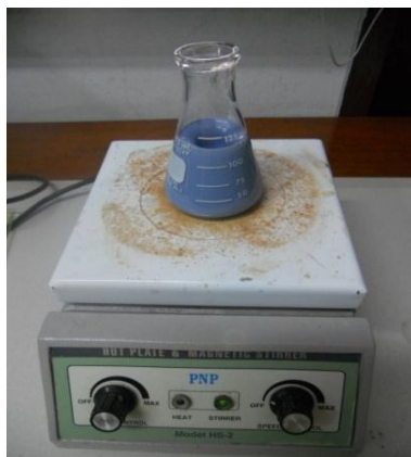
ภาพที่ 3.23 บิสมีทแบงผง ผสมกับน้ำยางธรรมชาติพีวีแอลไนด์และ น้ำยางสังเคราะห์เอสปีอาร์ทีที่ผสมแล้ว
