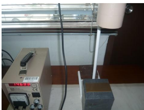
ภาพที่ 3.31 เครื่องมืออุปกรณ์ระบบวัดตัวอย่างแบบสารละลายบิสมีท์ 10%
