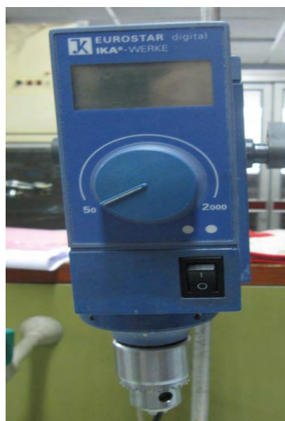
รูปที่ 26 แสดงเครื่องกวนสารแบบใบพัด (Propeller type mixer, EUROSTAR digital IKA WERKE)
