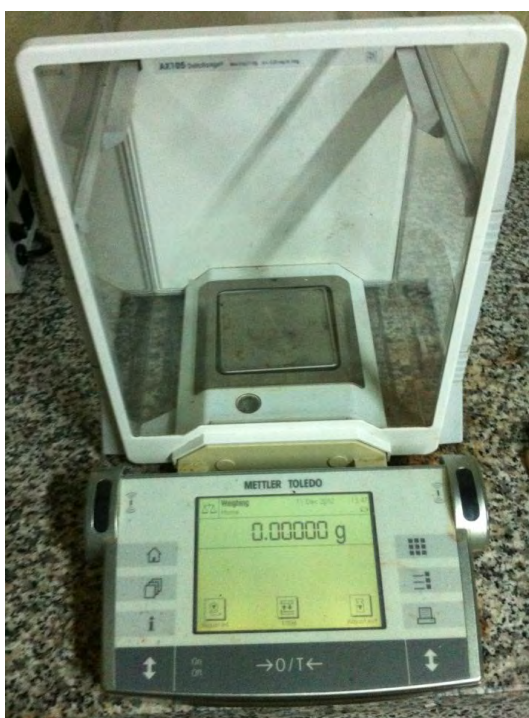
รูปที่ 28 แสดงเครื่องชั่งน้ำหนัก 5 ตำแหน่ง(METTLER TOLEDO® ไทย, รุ่น PG 403-S)
