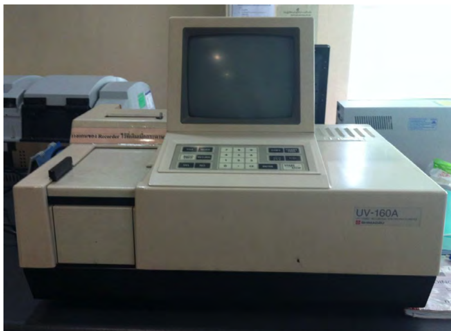
รูปที่ 32 แสดงเครื่องวัดการดูดกลืนแสง (UV spectrophotometer, SHIMADZU® ญี่ปุ่น, รุ่น UV-160A)
