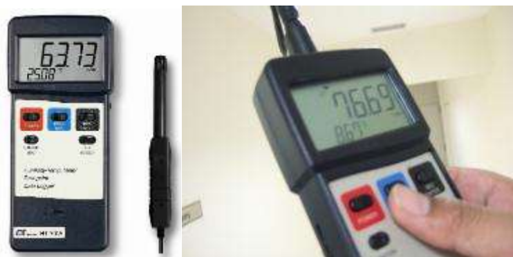
รูปที่ 4.7 อุปกรณ์วัดอุณหภูมิและความชื้นสัมพัทธ์อากาศ
