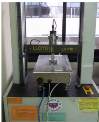
รูปที่ 10 แสดงเครื่องทดสอบแรงดึงอัดพร้อมอ่างควบคุมอุณหภูมิ 1
