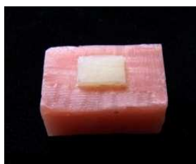
รูปที่ 13 แสดงชิ้นทดสอบการแปรง
