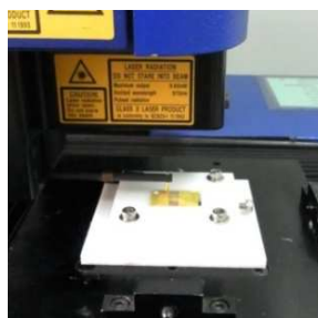
รูปที่ 17 แสดงการติดตั้งแท่นยึดชิ้นทดสอบบนแท่นวัดของเครื่องวัดความหยาบพื้นผิว
