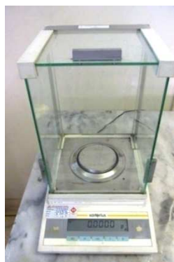
รูปที่ 14 แสดงเครื่องชั่งดิจิตอล 4 ตำแหน่ง ๑ (Electronic Semi-micro-, Analytical and Precision Balance ,Sartorius รุ่น BP110s ,Germany)
