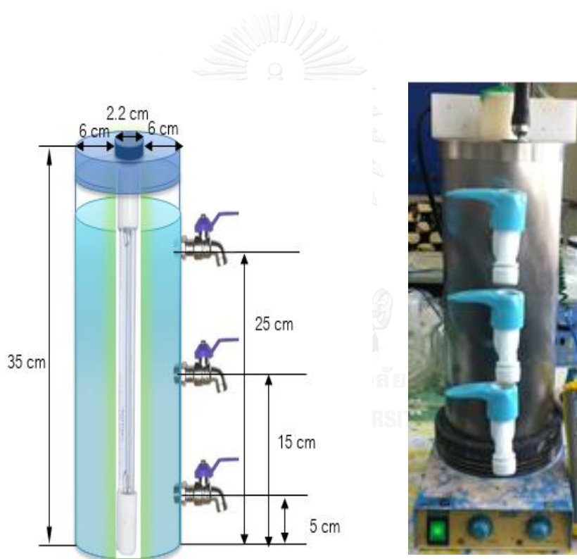
ภาพที่ 3.2 ถังปฏิกริยาแบบที่ละเท (Batch Reactor)
