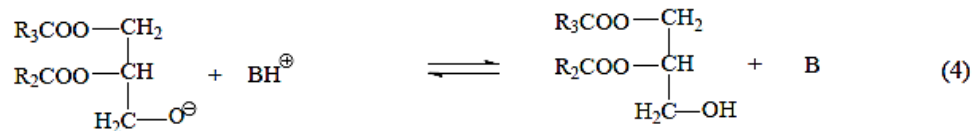
รูปที่ 2.6 กลไกการเกิดปฏิกิริยาทรานส์เอสเทอร์ฟิเคชัน [11]
