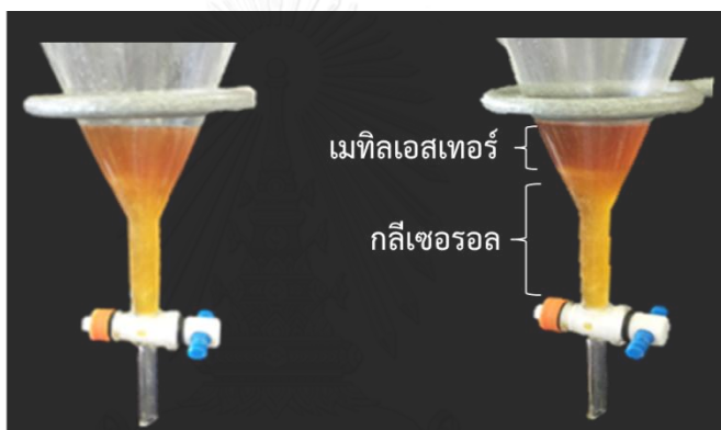
รูปที่ 3.8 ลักษณะผลิตภัณฑ์ตัวอย่างน้ำมันในขั้นตอนการกรองแยกกลีเซอรอล (ซ้าย) ตั้งทิ้งไว้ 5 นาที (ขวา) ตั้งทิ้งไว้ 20 นาที
