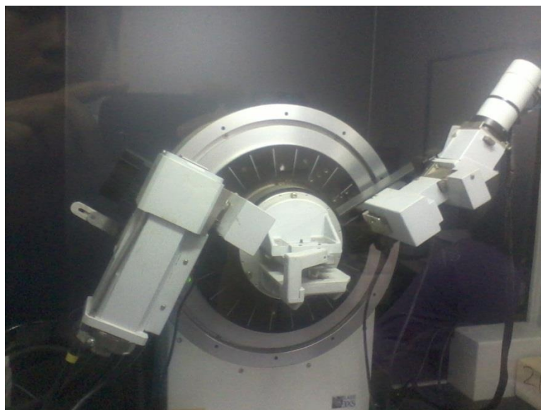
รูปที่ ก.2 เครื่องทดสอบการเลี้ยวเบนของรังสีเอ็กซ์ (XRD)
