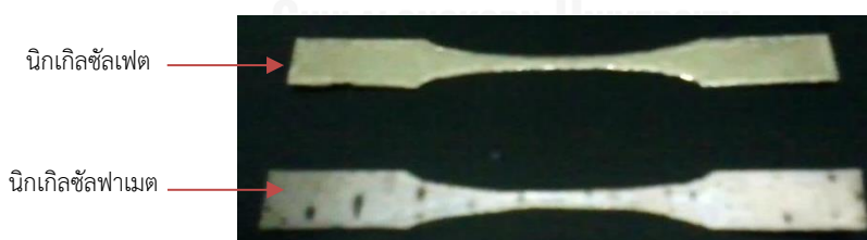
รูปที่ ก.4 ชิ้นงานตัวอย่างนิกเกิลรูปค้อน
