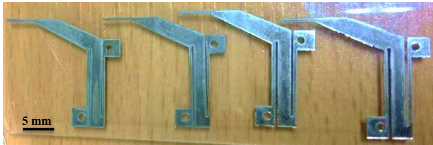
รูปที่ 3.6 ตัวอย่างชิ้นงานหลังจากทำกระบวนการไฟฟ้าเคมี
