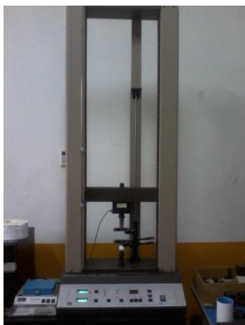
รูปที่ ก.5 เครื่องทดสอบแรงดึง Universal testing machine (Hounsfield H10KM)
