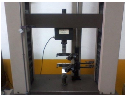
รูปที่ ก.5 เครื่องทดสอบแรงดึง Universal testing machine (Hounsfield H10KM)
