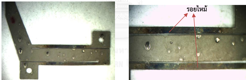
รูปที่ 5.10 ลักษณะรอยไหม้ที่เกิดขึ้นจากการจ่ายกระแสไฟฟ้า 5A
