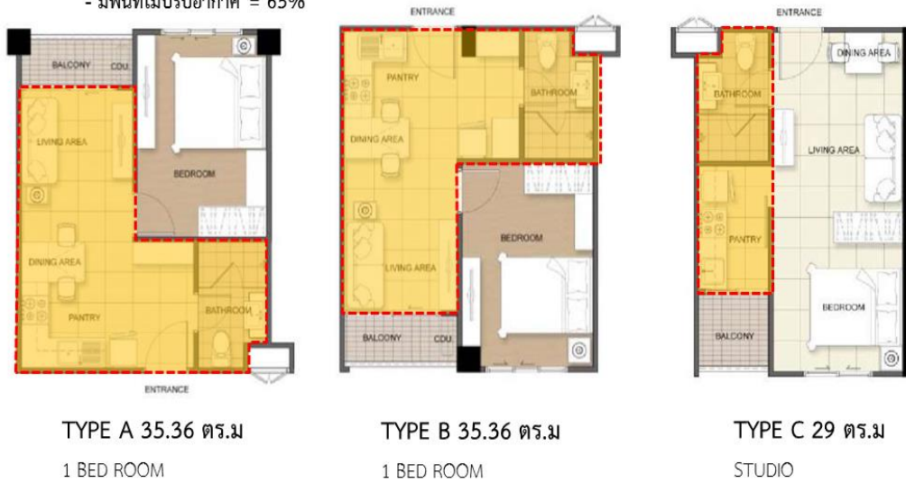
ภาพที่ 4.59 ผังแสดงมีพื้นที่ไม่ปรับอากาศ โครงการกรีนเพลส ปากเกร็ด
