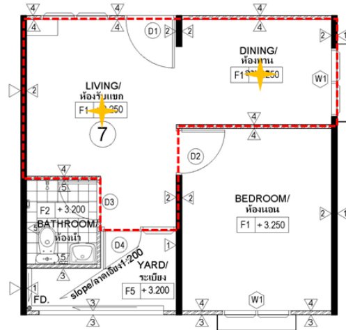
ภาพที่ 4.64 ผังแสดงค่าความส่องสว่างขั้นต่ำ พื้นที่ใช้งานหลัก โครงการบ้านเอื้ออาทรร่มเกล้า 2
