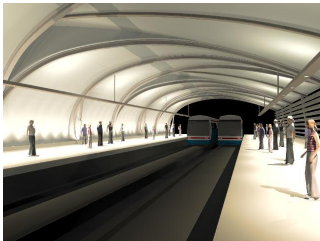
ภาพที่ 68 รูปแบบที่ 7 ให้แสงสม่ำเสมอที่ผนังและแสงไม่สม่ำเสมอที่เพดาน
