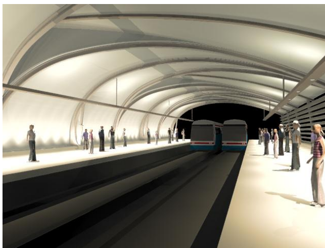
ภาพที่ 77 รูปแบบที่ 7 ให้แสงสม่ำเสมอที่ผนังและแสงไม่สม่ำเสมอที่เพดาน
