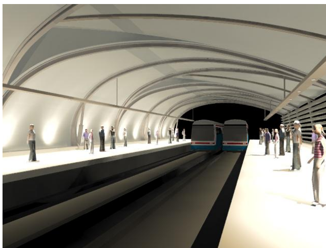
ภาพที่ 73 รูปแบบที่ 3 ให้แสงไม่สม่ำเสมอที่ผนัง
