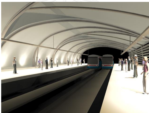
ภาพที่ 64 รูปแบบที่ 3 ให้แสงไม่สม่ำเสมอที่ผนัง
