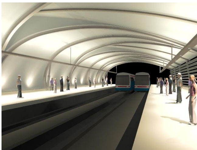
ภาพที่ 78 รูปแบบที่ 8 ให้แสงไม่สม่ำเสมอที่ผนังและแสงสม่ำเสมอที่เพดาน
