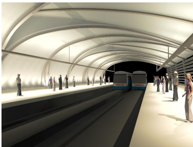
ภาพที่ 76 รูปแบบที่ 6 ให้แสงสม่ำเสมอที่ผนังและเพดาน
