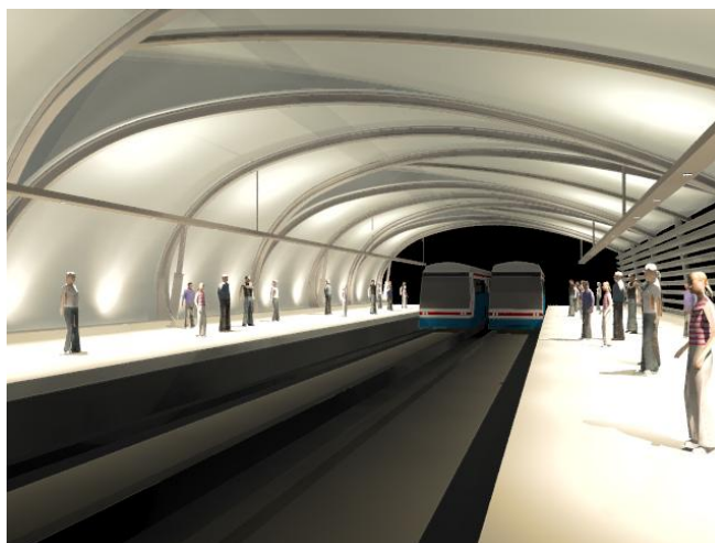
ภาพที่ 79 รูปแบบที่ 9 ให้แสงไม่สม่ำเสมอที่ผนังและเพดาน
