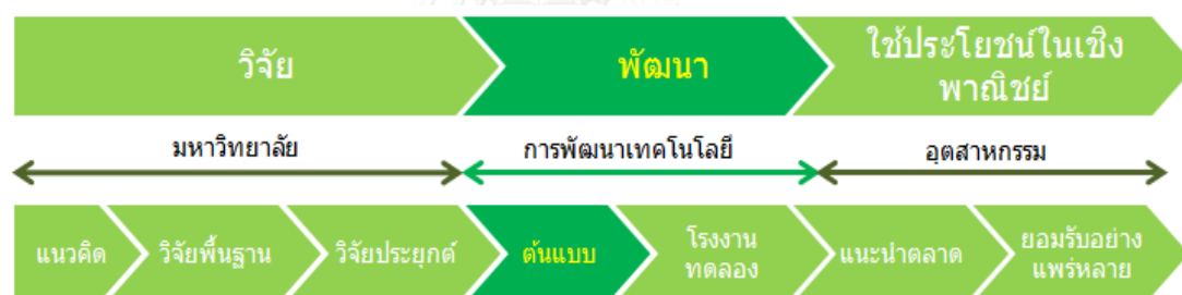
รูปที่ 5.1 ระดับขั้นของ เทคโนโลยี (Stage of Technology)
