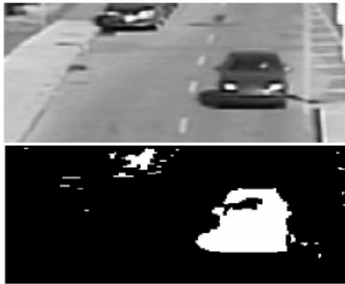
รูปที่ 2-12 ภาพแสดงการตัดแยกยานพาหนะที่มีเงาติดมา [11]
