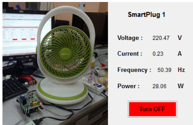
รูปที่ 5-14 ทดสอบกับพัดลมขนาด 27 W
