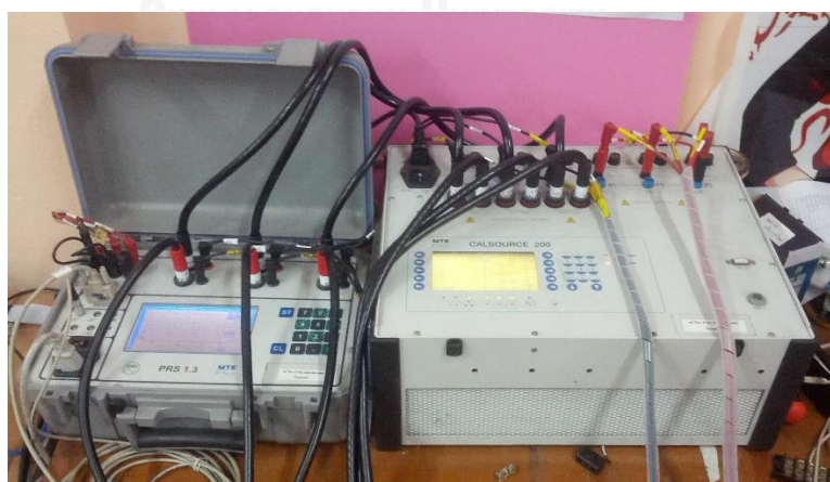
รูปที่ 3-21 เพาเวอร์มิเตอร์และเครื่องปรับเทียบ (Power Meter & Calibrator Source)
