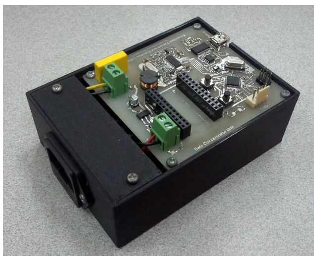
รูปที่ 5-3 ชุดต้นแบบตัวกลางการจัดการข้อมูล
