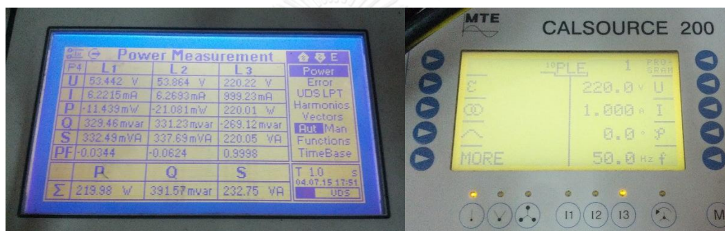
รูปที่ 3-22 แสดงค่าที่วัดได้จากเพาเวอร์มิเตอร์โดยจ่ายแรงดันและกระแสไฟฟ้าจากเครื่องปรับเทียบ
