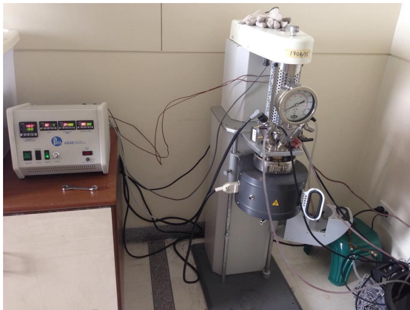
ภาพที่ 3.5 การปรับสภาพกากใยลิกโนเซลลูโลสของหัวมันสำปะหลัง โดยวิธีการระเบิดด้วยไอน้ำ
