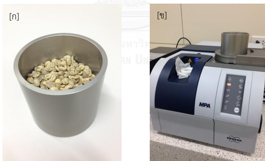
ภาพที่ 3.2 ตัวอย่างเมล็ดกาแฟสารในภาชนะสำหรับสแกนตัวอย่าง [ก], เครื่องฟูเรียร์ทรานสฟอร์มเนียร์อินฟราเรดสเปกโตรมิเตอร์ (Fourier Transform - Near infrared spectrometer; FT-NIR) รุ่น MPA [ข]
