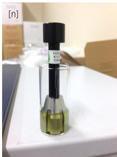
ภาพที่ 3.4 ภาพสำหรับสแกนตัวอย่างที่มีการวางเครื่องมือที่ทำให้เกิดการสะท้อน (transfection device) [ก], การสแกนสารสกัดหยาบด้วยเครื่องฟูรีเยร์ทรานสฟอร์มเนียร์อินฟราเรดสเปกโตรมิเตอร์ [ข]
