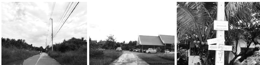
ภาพที่ 37 ลักษณะทางกายภาพในแหล่งท่องเที่ยวเชิงสร้างสรรค์ของชุมชนอัมพวา ถนนแคบ ไม่มีระบบส่องสว่าง (ภาพซ้าย) เส้นทางบางช่วงเป็นลูกรัง น้ำขัง เป็นโคลน เมื่อฝนตก (ภาพกลาง) ป้ายบอกทางขนาดเล็ก (ภาพขวา)
