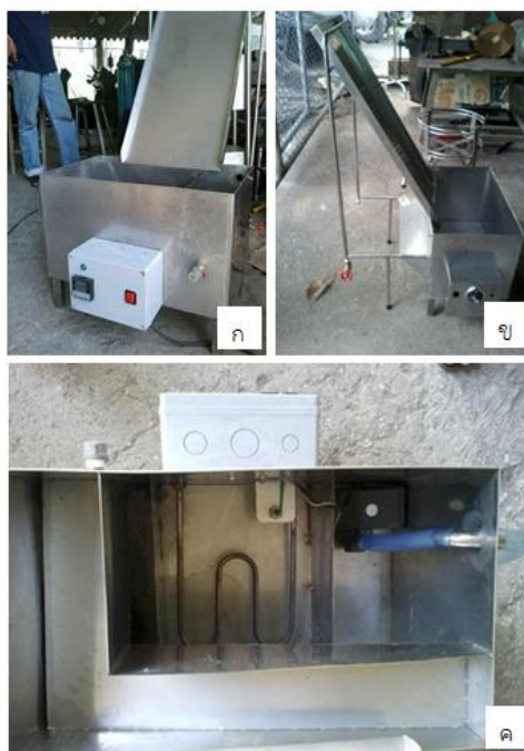
รูปที่ 3. 2 ลักษณะเครื่องทดสอบการกำจัดโลหะหนักด้วยสาหร่ายแบบสต่อระบบน้ำวนและความคุมอุณหภูมิ ขนาด 30x50x30 ลูกบาศก์เซนติเมตร (ก) ด้านหน้า (ข) ด้านข้าง และ (ค) ด้านในของตัวถัง
