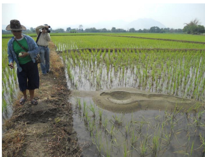
รูปที่ 1.2 การเกิดปรากฏการณ์ทรายเหลวที่อำเภอแม่สาย (ศูนย์วิจัยและพัฒนาวิศวกรรมปฐพีและฐานราก, 2557)
