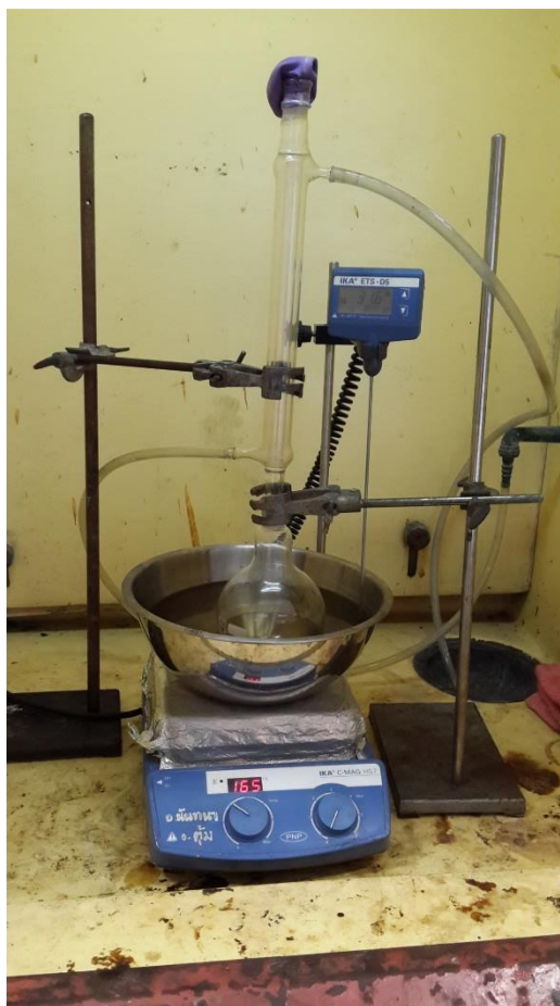
รูปที่ 3.5 การละลายของพอลิวิวทิลีนซัคซิเนตในคลอโรฟอร์ม
