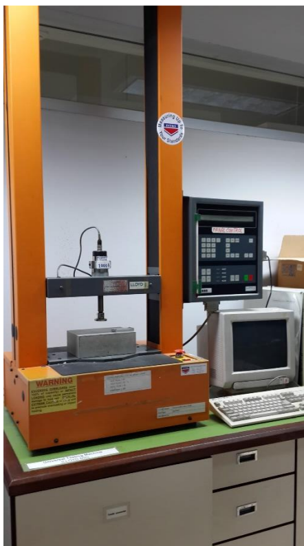
รูปที่ 3.14 เครื่องทดสอบอเนกประสงค์ติดตั้งชุดทดสอบความทนแรงดัดโค้ง
