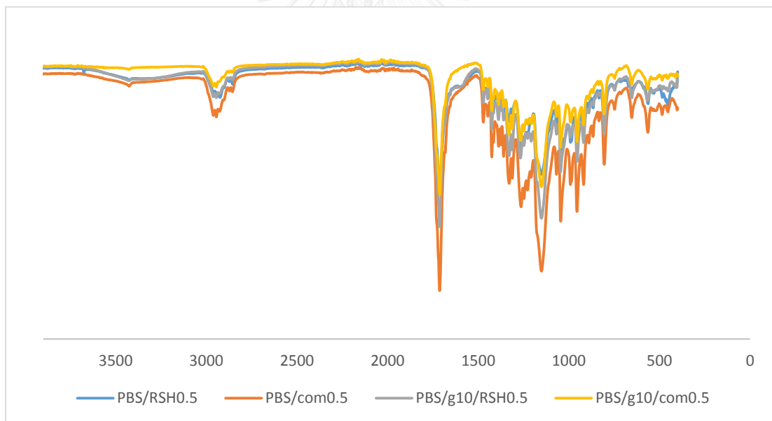
รูปที่ 4.5 อินฟราเรดสเปกตรัมของพอลิไวทิลีนซัคซิเนตคอมพอลิตที่มีการผสมและไม่ผสมสารเสริมสภาพความเข้ากันได้ที่ 10 phr
