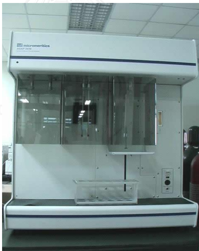
รูปที่ 3.8 เครื่องวิเคราะห์พื้นที่ผิวของอนุภาค
