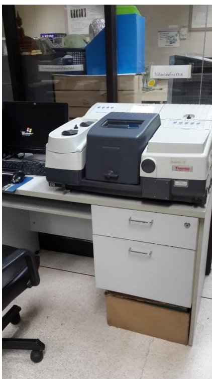
รูปที่ 3.6 เครื่องฟูเรียร์ทรานส์ฟอร์มอินฟราเรดสเปกโตรสโกปี
