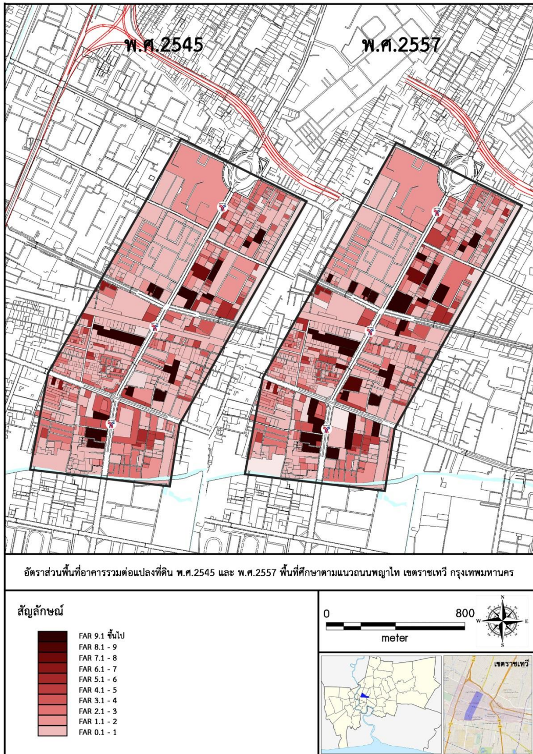
รูปที่ 40 : อัตราส่วนพื้นที่อาคารรวมต่อแปลงที่ดิน พ.ศ. 2545 และ พ.ศ. 2557 ตามแนวนถนนพญาไท เขตราชเทวี กรุงเทพมหานคร ที่มา : ปรับปรุงจากระบบสารสนเทศทางภูมิศาสตร์ สำนักผังเมืองกรุงเทพมหานคร
