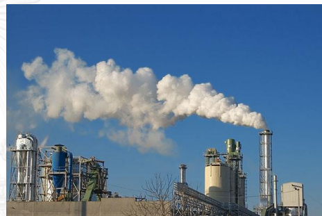
รูปที่ 1.1 เจ็ตในกระแสลมขวาง (ภาพถ่ายจากห้องปฏิบัติการวิจัยพลศาสตร์ของไหล ภาควิชาวิศวกรรมเครื่องกล คณะวิศวกรรมศาสตร์ จุฬาลงกรณ์มหาวิทยาลัย)
