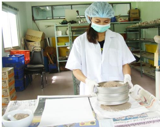
ภาพที่ ผ. 2 การเก็บตัวอย่างดินและการเตรียมตัวอย่างดินเพื่อวิเคราะห์
