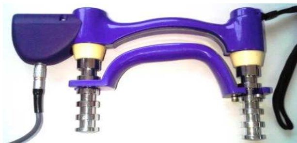
ภาพที่ 3.2 เครื่องวัดกำลังกล้ามเนื้อมือ Grip Dynamometer (G100) Biometrics E-LINK H400S Datalink Software version 5.0
