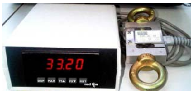
ภาพที่ 3.1 เครื่องวัดแรงดึง Tension / Compression Load cell Model No.616 พร้อม Digital Display Model PAX-1/8 DIN ANALOG INPUT PANEL METER
