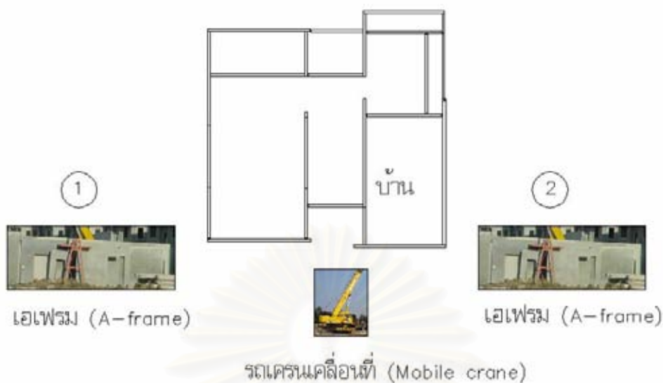
รูปที่ 5.22 ความสัมพันธ์ของตำแหน่งบ้าน รถเครน และเอเฟรม
