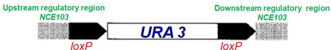
ภาพที่ 3.2 ผลิตรากฐาน PCR จากการที่ใช้ pUG72 เป็นดีเอ็นเอต้นแบบและมีฟอร์เวิร์ดกับรีเวิร์สไพรเมอร์ ( \Delta nce103 ) ที่จำเพาะต่อบริเวณด้าน 5' และ 3' ของยีน NCE103 ตามลำดับ
