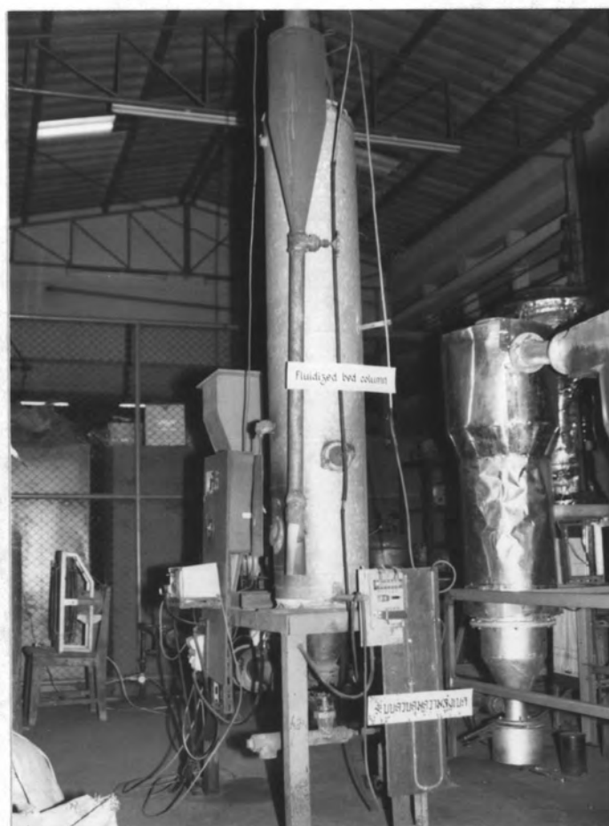
รูปที่ 3.8 ระบบควบคุมความสูงเบต และไฮโดรลน
