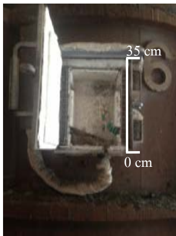
รูปที่ 6.5 กล่องป้องกันอุณหภูมิ แรงกระแทก และตัวที่ยึด Data Logger ติดกับเบ้ารับน้ำเหล็กตลอดเวลา การทำงาน
