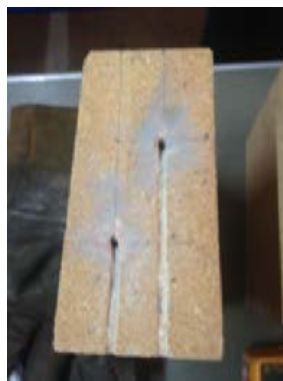
รูปที่ 6.3 การเจาะอิฐเพื่อฝังเทอร์คัปเปิ้ลชนิด K ลงไปอิฐทนไฟที่ตำแหน่ง 50 และ 100 มิลลิเมตร จากผิวที่สัมผัสน้ำเหล็ก
