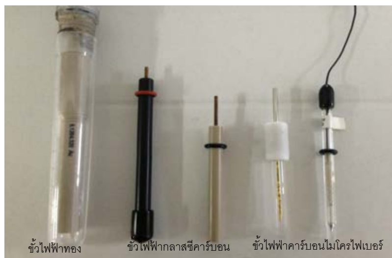
รูปที่ 2.7 ตัวอย่างขั้วไฟฟ้าที่ถูกพัฒนาขึ้นเพื่อใช้แทนขั้วไฟฟ้าปรอท (ขั้วไฟฟ้าทอง, ขั้วไฟฟ้าทังสเตนคาร์บอน และขั้วไฟฟ้าคาร์บอนไมโครไฟเบอร์)
