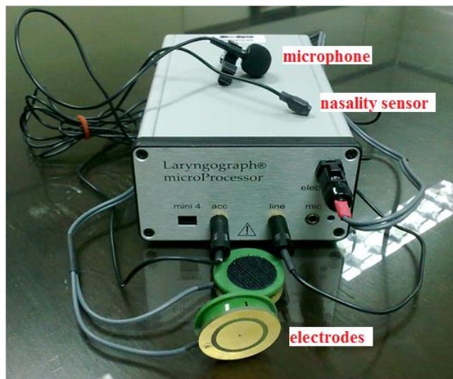
ภาพที่ 3.1 เครื่อง MicroProcessor Speech Studio ไมโครโฟน electrodes และ nasality sensor ของภาควิชาภาษาศาสตร์ คณะอักษรศาสตร์ จุฬาลงกรณ์มหาวิทยาลัย
