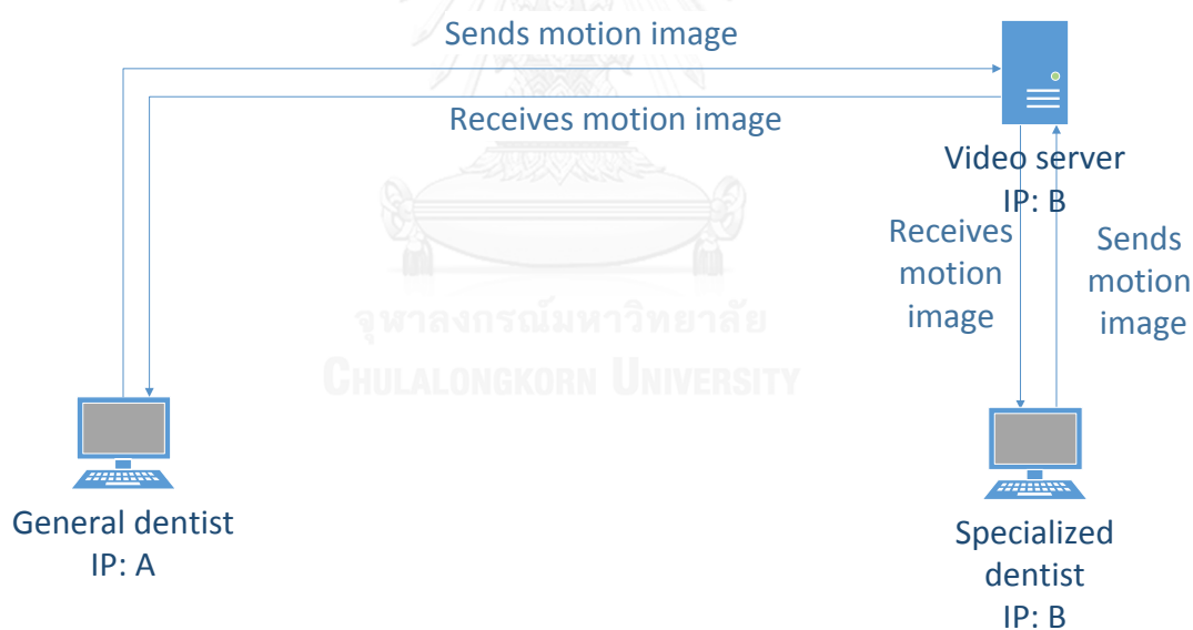
ภาพที่ 24 แผนภาพการทำงานของระบบสนทนาทางจอภาพ
