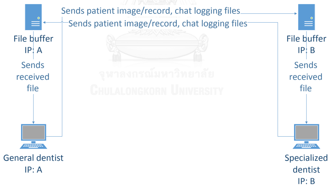
ภาพที่ 26 แผนภาพการทำงานของระบบรับ-ส่งไฟล์ภาพและประวัติผู้ป่วย
