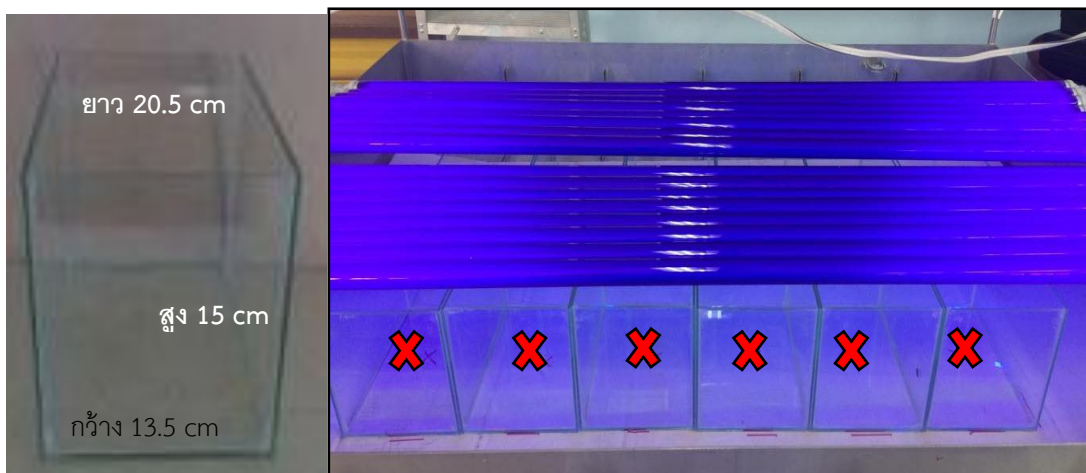
รูปที่ 3-11 ตู้ทดลองและลักษณะการวางหลอดไฟ
