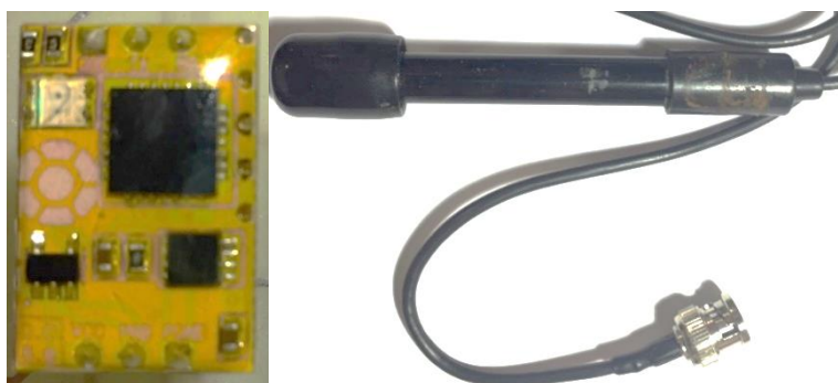
รูปที่ 3.7 เซนเซอร์ D.O. Circuit รุ่น 6.0 พร้อมหัววัด
