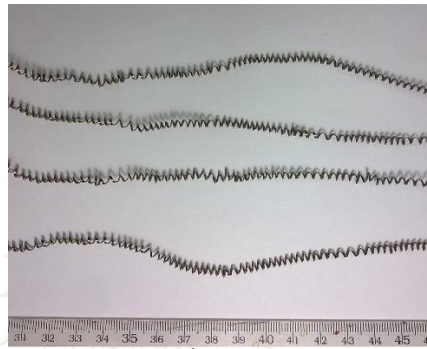
รูปที่ 4.1 ลักษณะเศษโลหะจากการตัดภายใต้เงื่อนไขการตัด ได้แก่ ความเร็วตัด 200 ม.ต่อนาที อัตราป้อนตัด 0.15 มม.ต่อรอบ ความลึกในการตัด 0.4 มม. รัศมีจุมุกมีด 0.4 มม. และมุมคายเศษโลหะ 11
