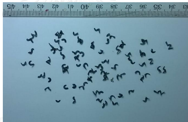
รูปที่ 4.10 ลักษณะเศษโลหะจากการตัดภายใต้เงื่อนไขการตัด ได้แก่ ความเร็วตัด 100 ม.ต่อนาที อัตราป้อนตัด 0.25 มม.ต่อรอบ ความลึกในการตัด 0.8 มม. รัศมีจุมุมมีด 0.8 มม. และมุมคายเศษ
