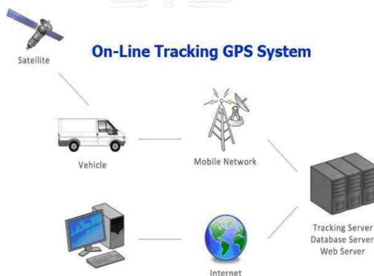
รูปที่ 2. 15 หลักการทำงานของ GPS Tracking แบบ Online (ที่มา: http://rsu-itm640.blogspot.com/2010/08/gps.html )
