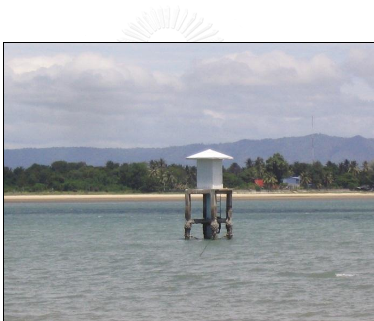
รูปที่ 2.8 สถานีวัดระดับน้ำเกาะหลัก อ.เมือง จ.ประจวบคีรีขันธ์ (เอี่ยมเกียรติ เจริญสม, 2549)
