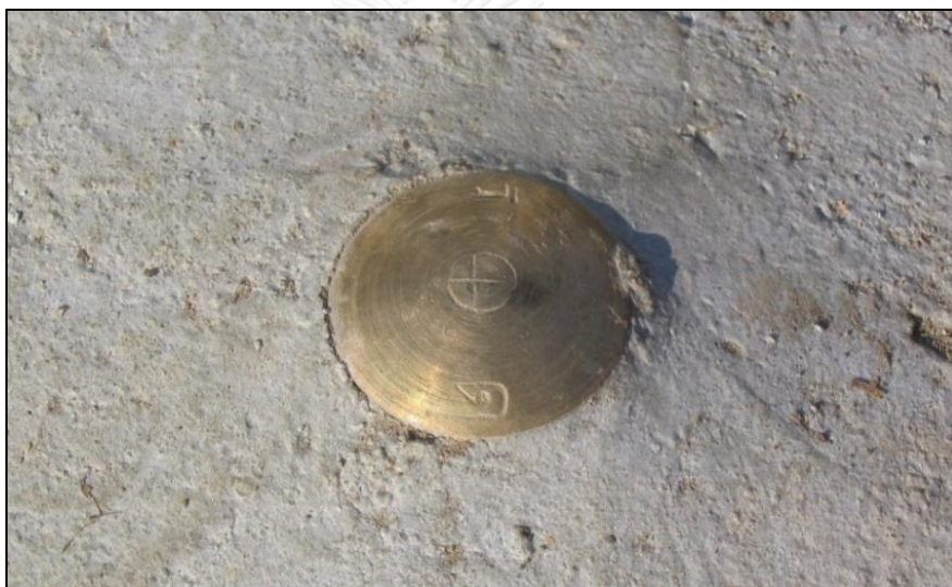
รูปที่ 2.2 ตัวอย่างหมุดหลักฐาน SBM. แบบ ซ. (กรมแผนที่ทหาร, 2555)
