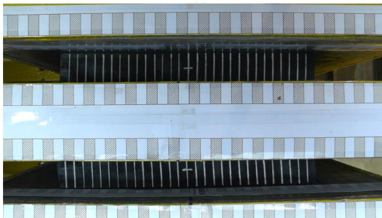
รูปที่ 5.7 T40 ระยะ +10mm ที่ 0.01 Hz.
