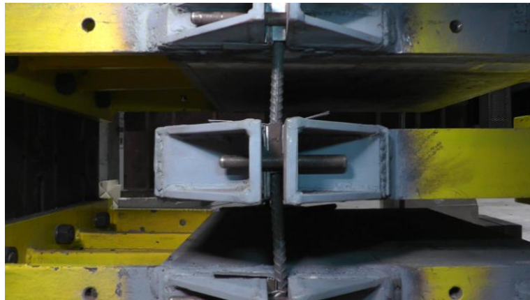
รูปที่ 7.10 ระยะเคลื่อนตัว 5 มิลลิเมตร ในทิศทางบวกของตัวอย่าง S12-80
