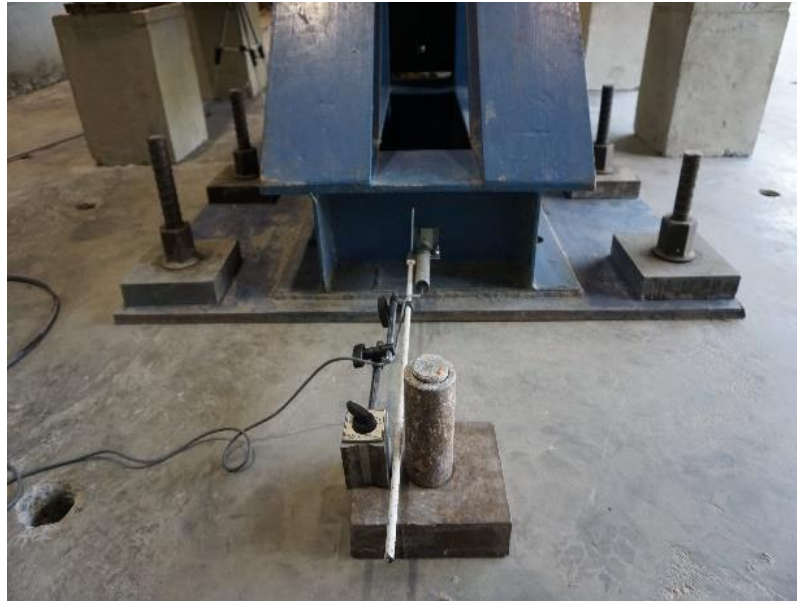
รูปที่ 4.10 ตรวจสอบการเคลื่อนตัวของโครงสร้างเหล็กรับแรงในแนวราบ
