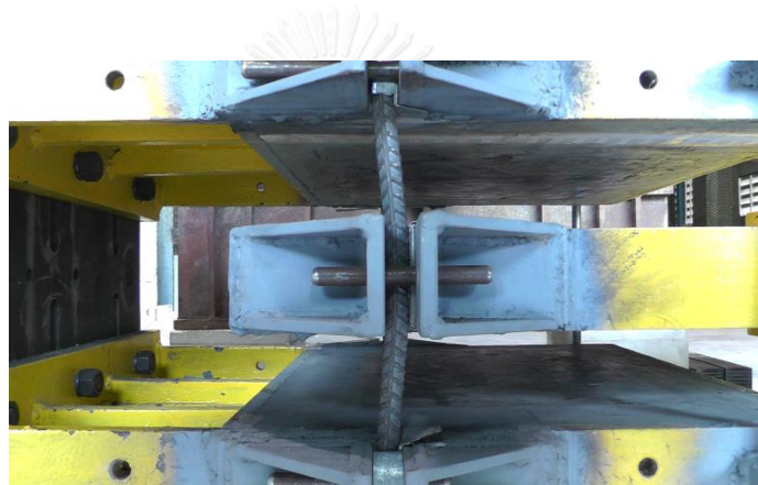
รูปที่ 7.33 ระยะเคลื่อนตัว 10 มิลลิเมตร ในทิศทางลบของตัวอย่าง S16-80
