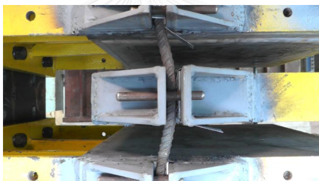
รูปที่ 7.27 ระยะเคลื่อนตัว 19 มิลลิเมตร ในทิศทางบวกของตัวอย่าง S16-60
