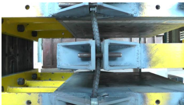
รูปที่ 7.35 ระยะเคลื่อนตัว 15 มิลลิเมตร ในทิศทางลบของตัวอย่าง S16-80
