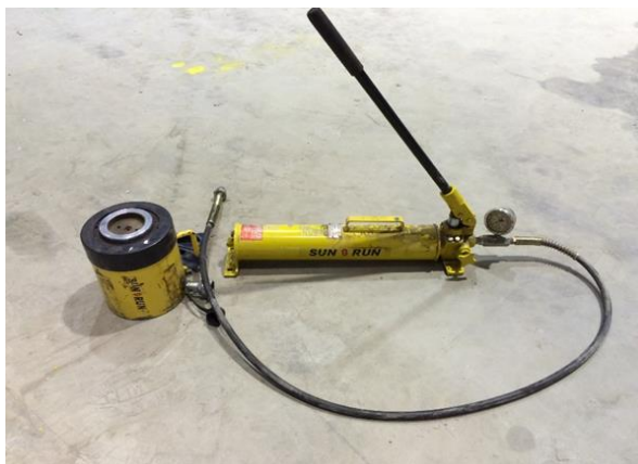
รูปที่ 4.5 แท่นไฮดรอลิกให้แรงอัดในแนวตั้ง
