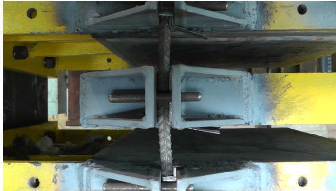
รูปที่ 7.20 ระยะเคลื่อนตัว 5 มิลลิเมตร ในทิศทางบวกของตัวอย่าง S16-60
