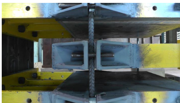
รูปที่ 7.29 ลักษณะก่อนการทดสอบเหล็กเดือย S16-80
