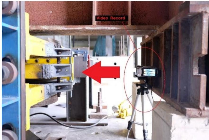
รูปที่ 6.6 การบันทึกภาพในระหว่างทดสอบ
