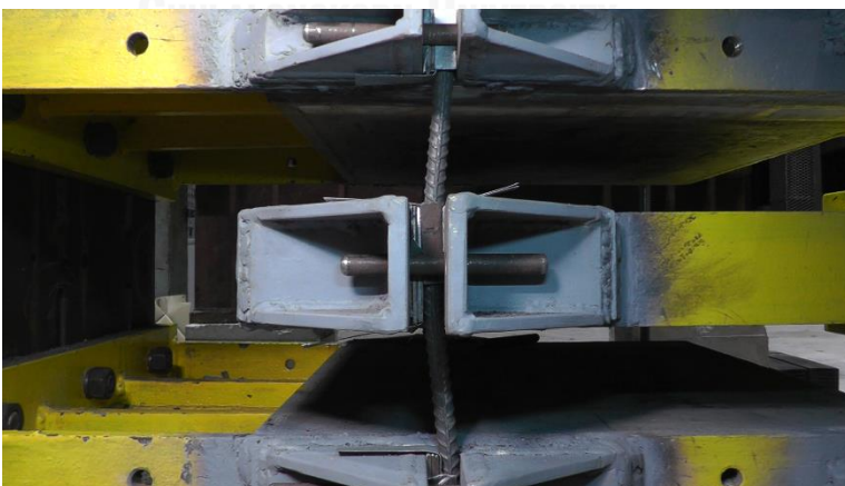
รูปที่ 7.12 ระยะเคลื่อนตัว 10 มิลลิเมตร ในทิศทางบวกของตัวอย่าง S12-80
