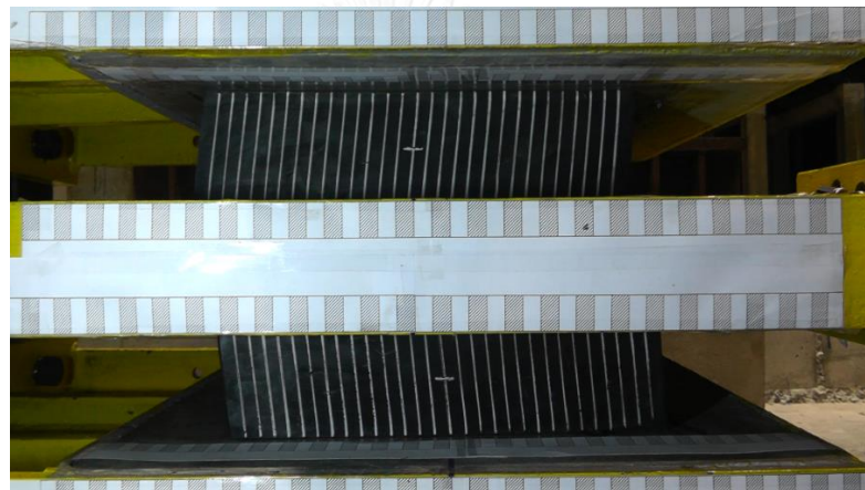
รูปที่ 5.25 T80 ระยะ +20mm ที่ 0.01 Hz.
