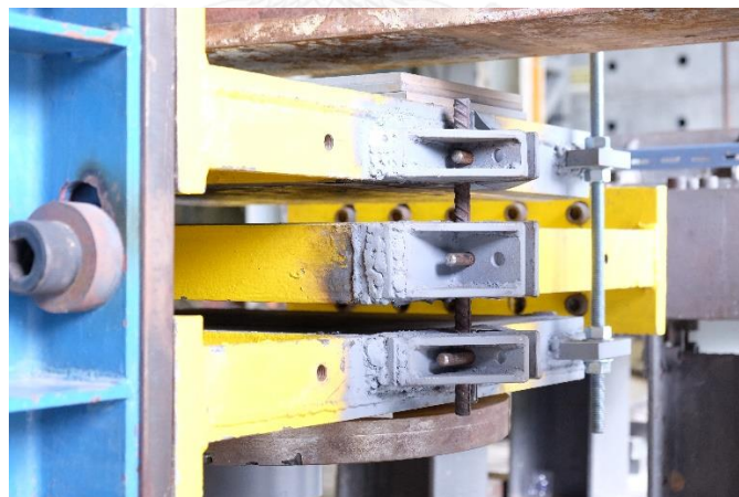
รูปที่ 6.5 การติดตั้งเหล็กเดือยทางด้านซ้ายมือของชุดทดสอบ
