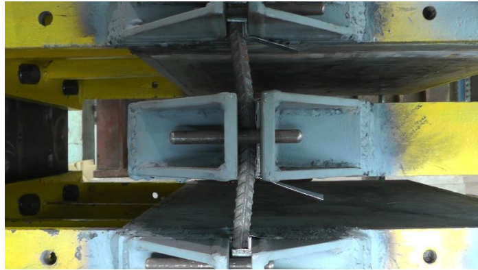
รูปที่ 7.23 ระยะเคลื่อนตัว 10 มิลลิเมตร ในทิศทางลบของตัวอย่าง S16-60
