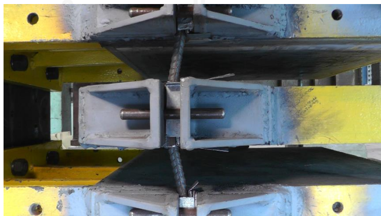
รูปที่ 7.4 ระยะเคลื่อนตัว 15 มิลลิเมตร ในทิศทางบวกของตัวอย่าง S12-60
