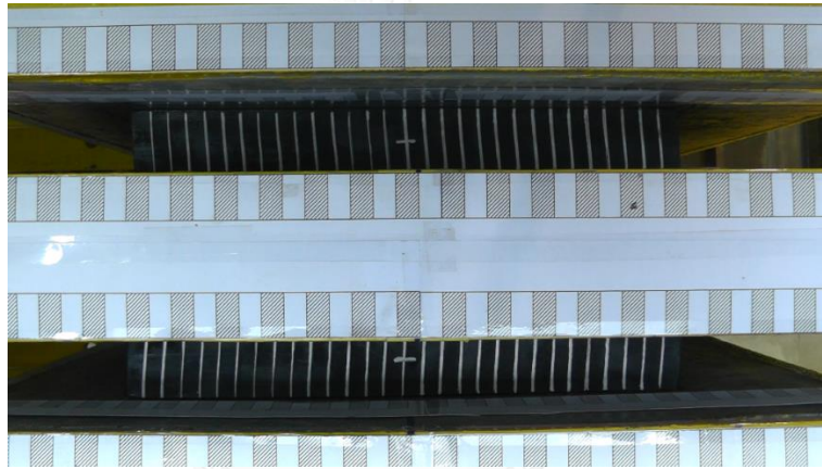
รูปที่ 5.6 T40 ระยะ -6mm ที่ 1.0 Hz.
