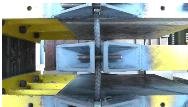
รูปที่ 7.31 ระยะเคลื่อนตัว 5 มิลลิเมตร ในทิศทางบวกของตัวอย่าง S16-80
