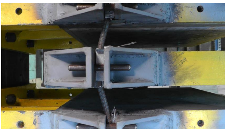
รูปที่ 7.6 ระยะเคลื่อนตัว 20 มิลลิเมตร ในทิศทางบวกของตัวอย่าง S12-60
