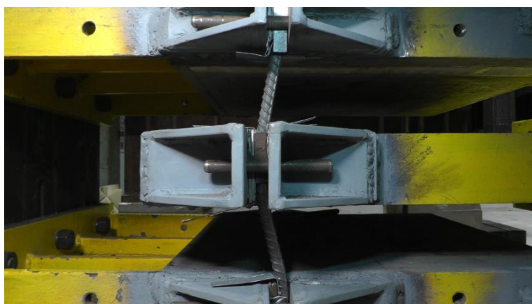
รูปที่ 7.16 ระยะเคลื่อนตัว 21 มิลลิเมตร ในทิศทางบวกของตัวอย่าง S12-80
