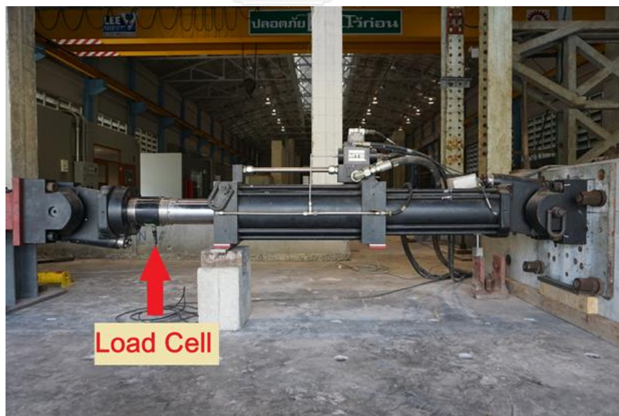
รูปที่ 6.7 เครื่องวัดแรงของเครื่องไฮดรอลิก
