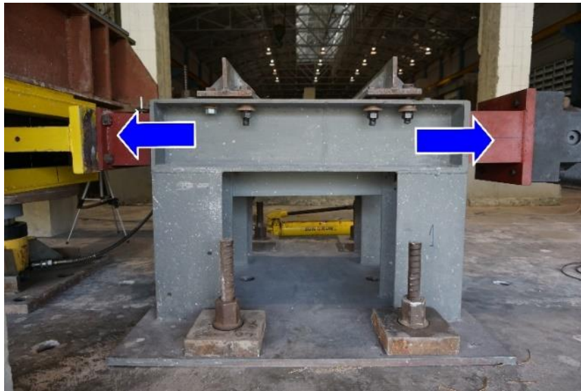
รูปที่ 4.7 โครงเหล็กแบบล้อเลื่อน
