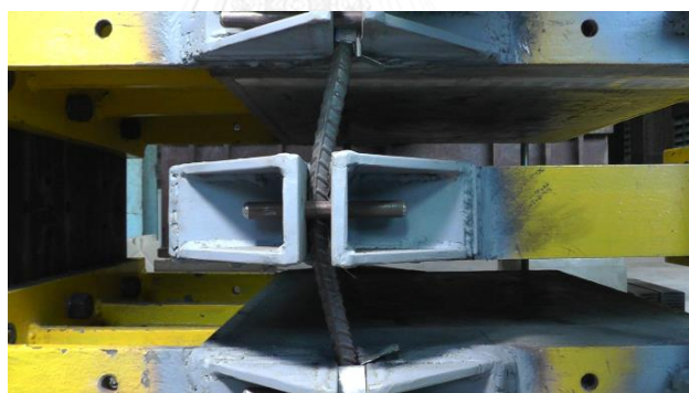
รูปที่ 7.36 ระยะเคลื่อนตัว 22 มิลลิเมตร ในทิศทางบวกของตัวอย่าง S16-80
