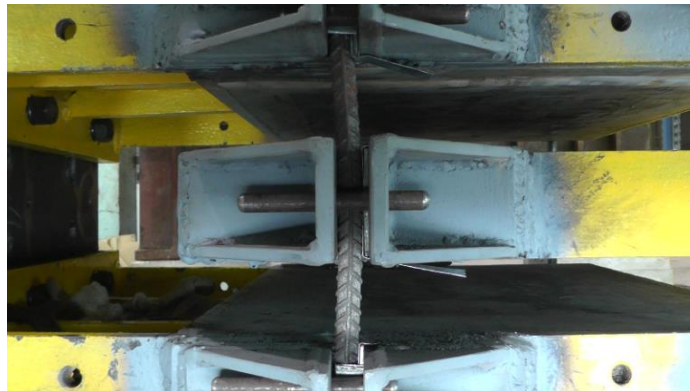
รูปที่ 7.21 ระยะเคลื่อนตัว 5 มิลลิเมตร ในทิศทางลบของตัวอย่าง S16-60
