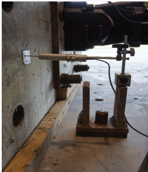
รูปที่ 4.11 ตรวจสอบการเคลื่อนตัวของบล็อกคอนกรีต
