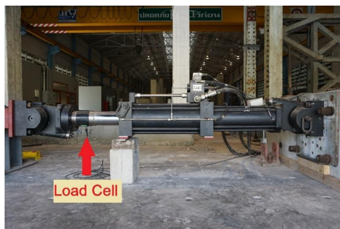
รูปที่ 4.4 เครื่องให้แรงแบบไฮดรอลิก (Actuator)
