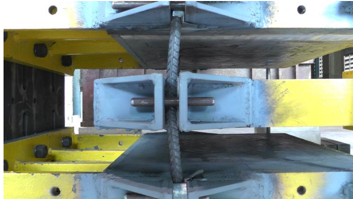
รูปที่ 7.32 ระยะเคลื่อนตัว 10 มิลลิเมตร ในทิศทางบวกของตัวอย่าง S16-80
