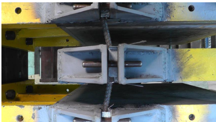
รูปที่ 7.5 ระยะเคลื่อนตัว 15 มิลลิเมตร ในทิศทางลบของตัวอย่าง S12-60
