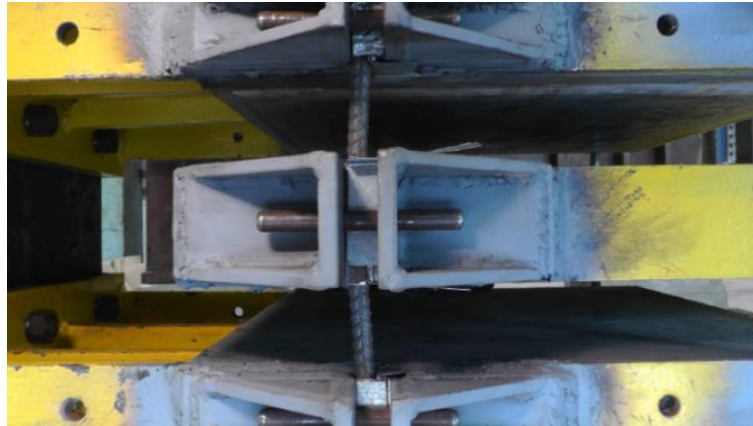
รูปที่ 7.2 ระยะเคลื่อนตัว 5 มิลลิเมตร ในทิศทางบวกของตัวอย่าง S12-60
