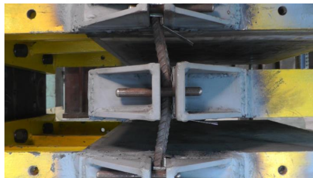
รูปที่ 7.25 ระยะเคลื่อนตัว 15 มิลลิเมตร ในทิศทางลบของตัวอย่าง S16-60
