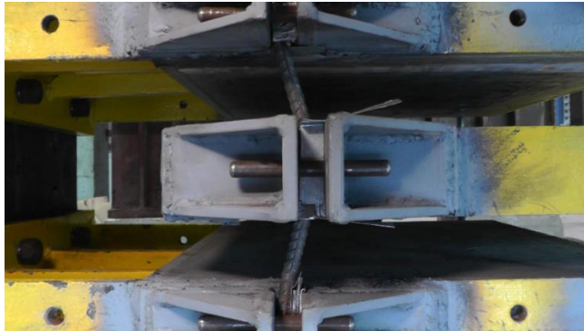
รูปที่ 7.7 ระยะเคลื่อนตัว 20 มิลลิเมตร ในทิศทางลบของตัวอย่าง S12-60
