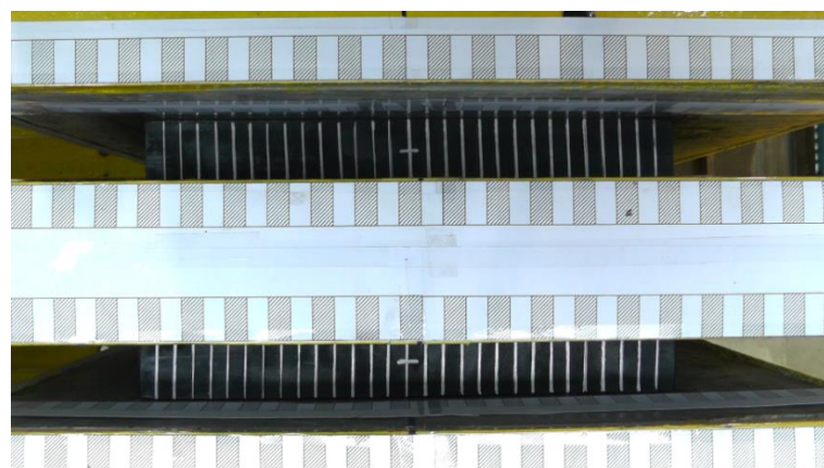
รูปที่ 5.4 T40 ระยะ -6mm ที่ 0.01 Hz.
