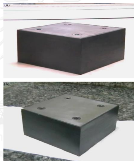
รูปที่ 2.15 แบบของตัวอย่างทดสอบ (a) ตัวอย่างที่เสริมแรงด้วยไฟเบอร์ (b) ตัวอย่างที่เสริมแรงด้วยเหล็ก (Ashkezarria .G .D et.al 2008)
