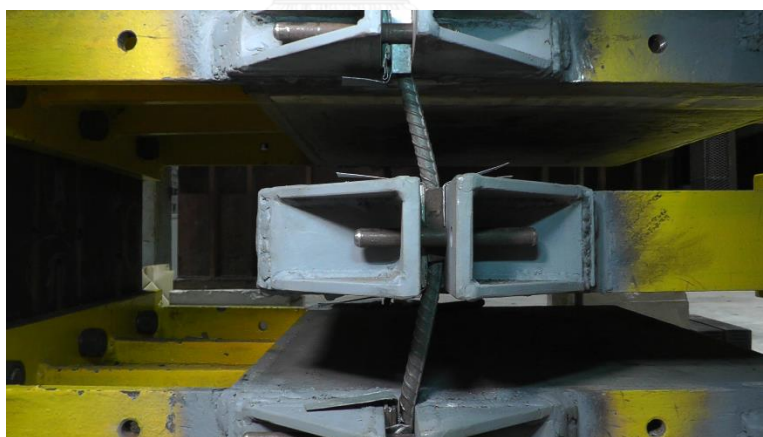
รูปที่ 7.17 ระยะเคลื่อนตัว 21 มิลลิเมตร ในทิศทางลบของตัวอย่าง S12-80
