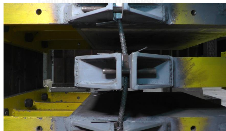
รูปที่ 7.15 ระยะเคลื่อนตัว 15 มิลลิเมตร ในทิศทางลบของตัวอย่าง S12-80
