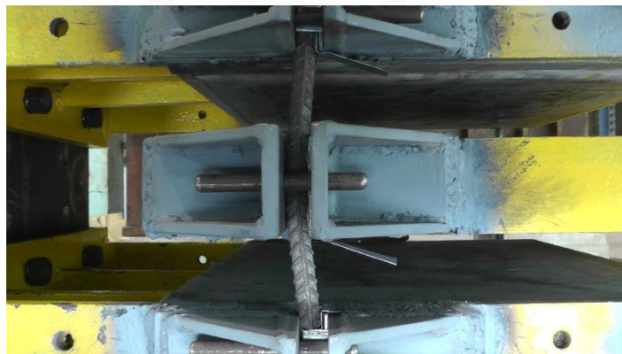
รูปที่ 7.22 ระยะเคลื่อนตัว 10 มิลลิเมตร ในทิศทางบวกของตัวอย่าง S16-60
