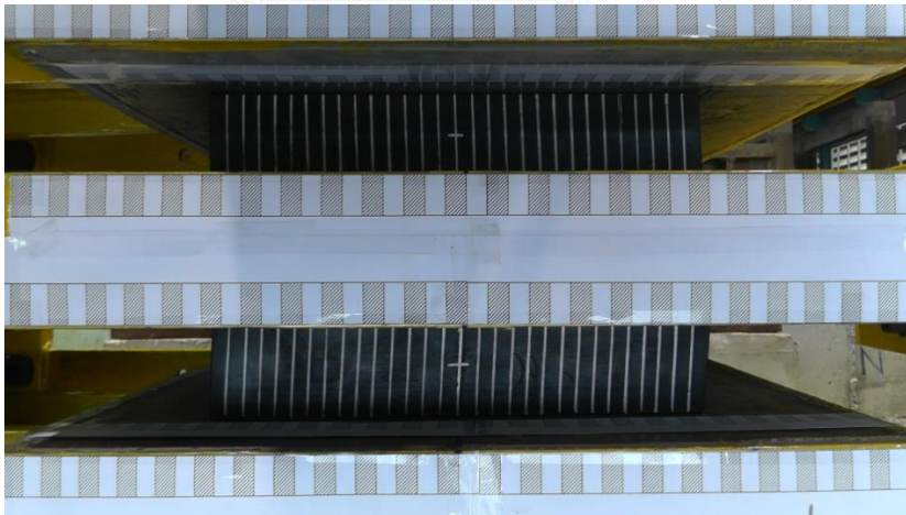
รูปที่ 5.12 T60 ระยะ -6mm ที่ 0.01 Hz.
