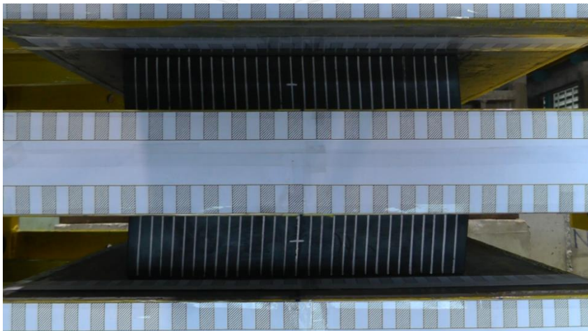
รูปที่ 5.14 T60 ระยะ -6mm ที่ 1.0 Hz.
