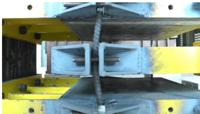
รูปที่ 7.34 ระยะเคลื่อนตัว 15 มิลลิเมตร ในทิศทางบวกของตัวอย่าง S16-80
