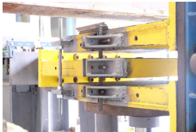
รูปที่ 6.4 การติดตั้งเหล็กเดือยทางด้านขวาของชุดทดสอบ
