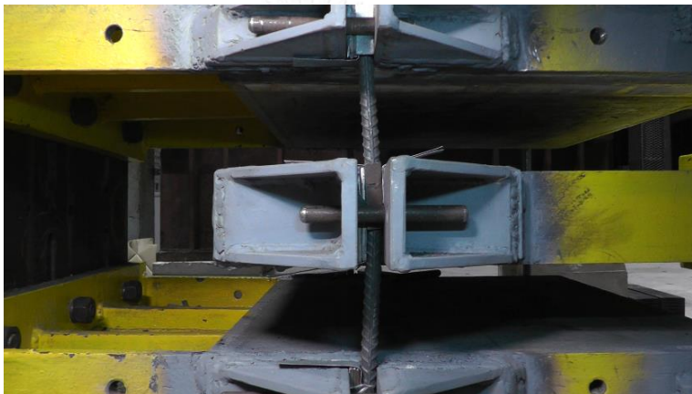
รูปที่ 7.11 ระยะเคลื่อนตัว 5 มิลลิเมตร ในทิศทางลบของตัวอย่าง S12-80
