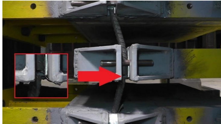
รูปที่ 7.38 ระยะเคลื่อนตัว 28 มิลลิเมตร ในทิศทางลบของตัวอย่าง S16-80
