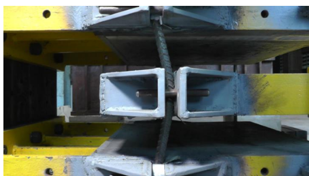
รูปที่ 7.37 ระยะเคลื่อนตัว 22 มิลลิเมตร ในทิศทางลบของตัวอย่าง S16-80
