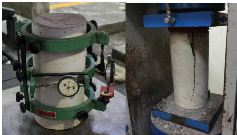
รูปที่ 4.1 การทดสอบตัวอย่างคอนกรีตรูปทรงกระบอก
