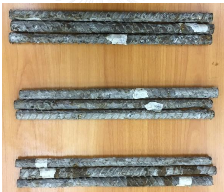
รูปที่ 4.2 การชั่งน้ำหนักเหล็กเสริมเพื่อคำนวณหน้าตัดเหล็กที่เปลี่ยนแปลงเนื่องจากการกัดกร่อน
