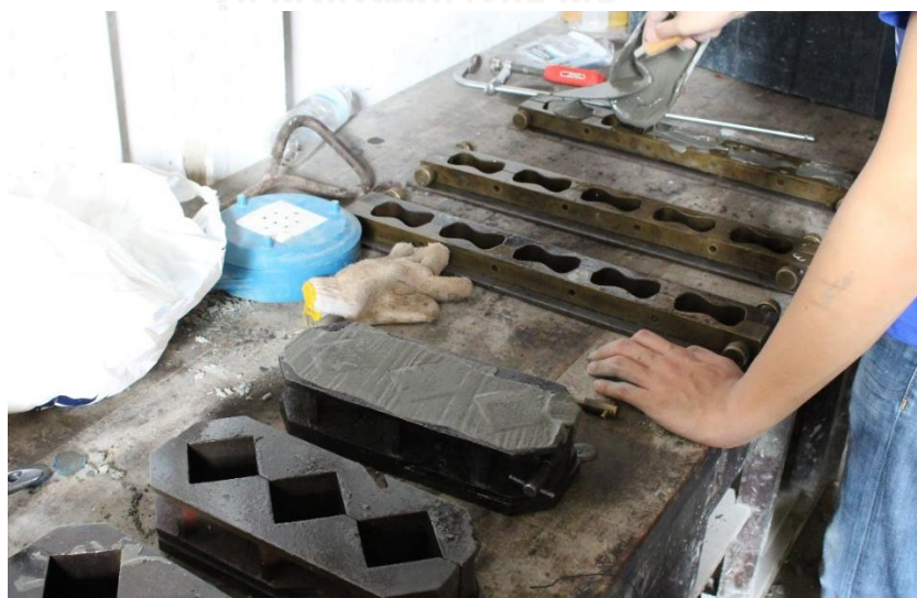
รูปที่ 3.17 การเก็บตัวอย่างเพื่อทดสอบคุณสมบัติของวัสดุผสม
