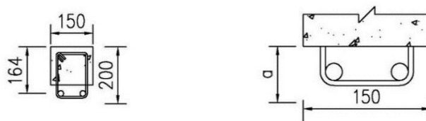
รูปที่ 3.9 ระยะการสกัดคอนกรีต
