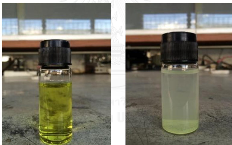
ภาพที่ 4.9 เปรียบเทียบการละลายน้ำของ \text{H}_3\text{PMo}_{12}\text{O}_{40} และ \text{Cs}_x\text{H}_{3-x}\text{PMo}_{12}\text{O}_{40}
