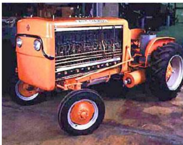
ภาพที่ 2.2 รถแทรกเตอร์เซลล์เชื้อเพลิง ผลิตโดยบริษัท Allis-Chalmers [7]
