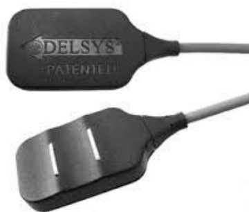
รูปที่ 5 ขั้วบันทึกสัญญาณไฟฟ้ากล้ามเนื้อ เส้นผ่านศูนย์กลาง 10 มิลลิเมตร โปรแกรมการวิเคราะห์คลื่นไฟฟ้ากล้ามเนื้อ EMGworks 3.6 ผลิตโดย Delsys Incorporated, United states of America
