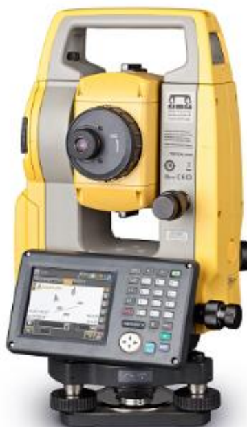
รูปที่ 4 กล้องประมวลผลรวม (Total Station) ของ Topcon รุ่น DS-101AC
