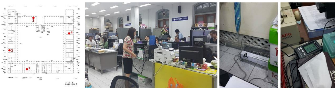
ภาพที่ 4.17 จุดที่ติดตั้งเครื่องมือวัดอุณหภูมิและความชื้นสัมพัทธ์ของกรณีศึกษาที่ 3
