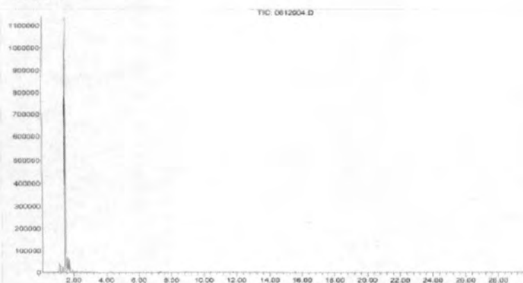
รูปที่ 4.7 กราฟแสดงผลการวิเคราะห์ปริมาณของสารปนเปื้อนที่ตกค้างบนตัวทำละลายอินทรีย์ High Clean AI โดยใช้เทคนิค Gas Chromatography –Mass Spectrometer( GC-MS )
