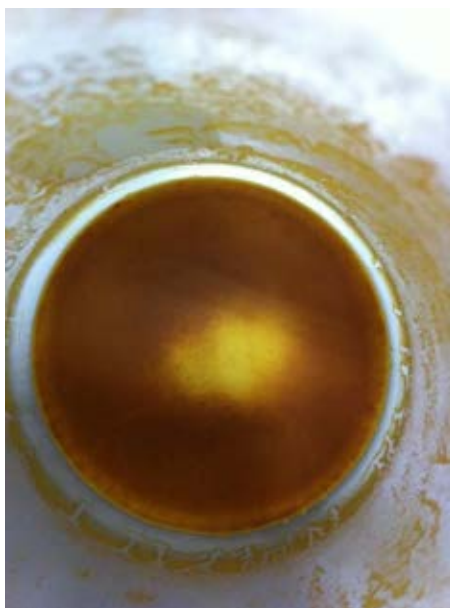
ภาพที่ ฅ.1 การเติมเอมีนที่มากเกินไปหลังจากนำไปอบที่อุณหภูมิ 60 องศาเซลเซียส
