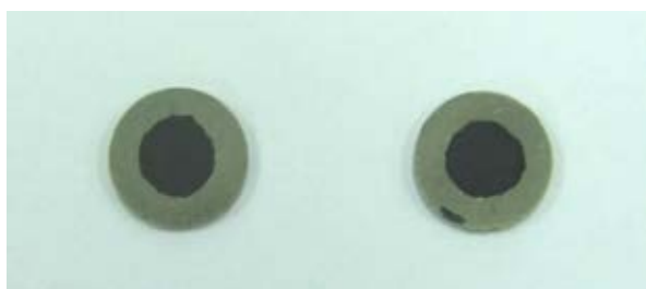
ภาพที่ 3.3 ตัวอย่างการทำเส้นใยลงบนเม็ดยึดเล็กโทรไลต์
