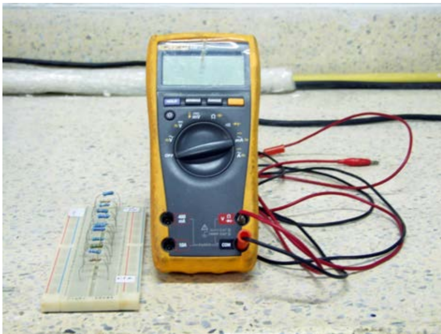
ภาพที่ 3.7 อุปกรณ์ในการวัดความต่างศักย์และชุดตัวต้านทาน
