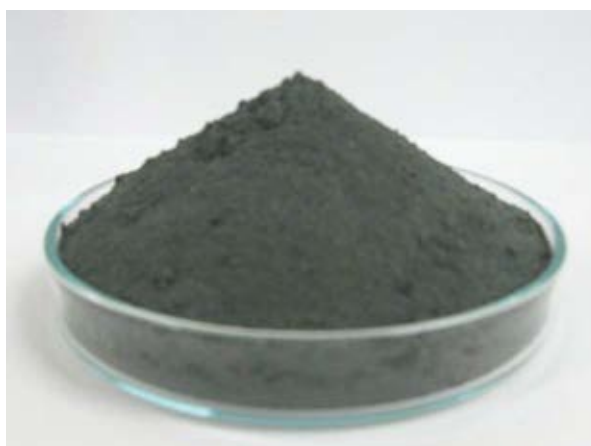
ภาพที่ 2.4 ฝุ่นผงสังกะสีจากระบวนการชุบสังกะสีแบบจุ่มร้อน
