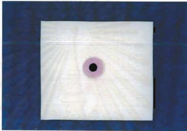
ภาพที่ 22 แสดงแบบสำหรับหล่อวัสดุชนิดหินหลอมร่องฟัน
