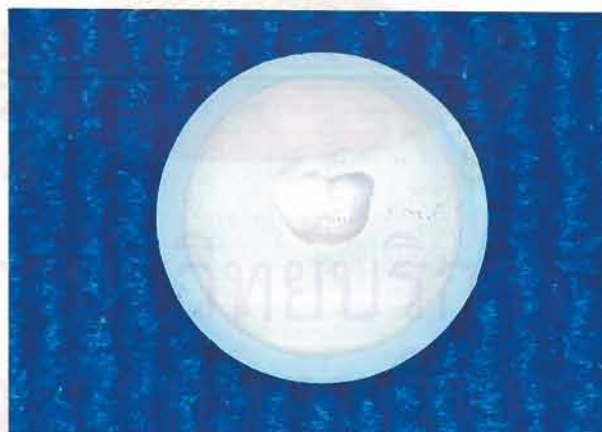
ภาพที่ 21 แสดงชิ้นตัวอย่างที่ยึดลงในกระบอกพลาสติกด้วยพลาสติกหิ้น
