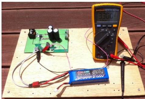
(ก) วงจรสำหรับทดสอบเสถียรภาพต่ออุณหภูมิ
