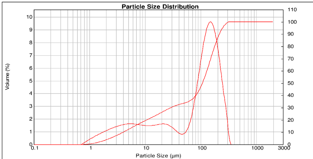
ภาพที่ ก- 49 แสดงข้อมูลการทดสอบขนาดอนุภาคผงปูน Investment T ครั้งที่ 2
