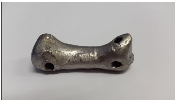
ภาพที่ 2.7 แสดงกระดูกไทเทเนียมที่ทดแทนกระดูกในร่างกายมนุษย์
