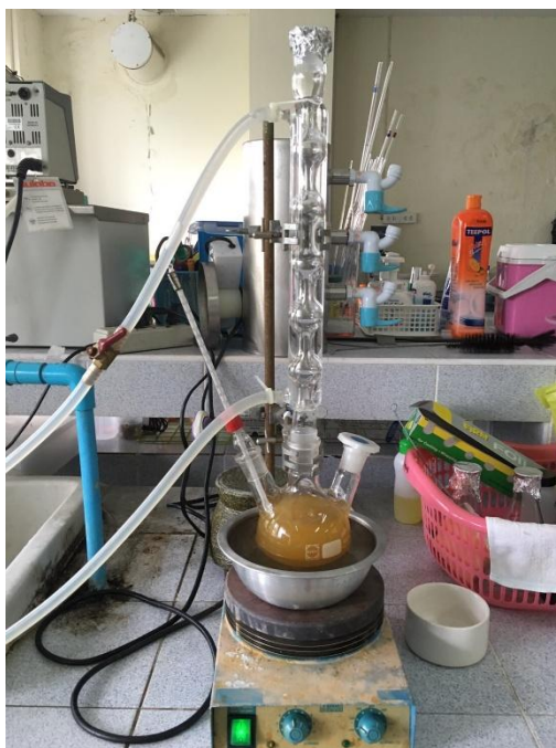
ภาพที่ จ-1 การติดตั้งอุปกรณ์ในการศึกษาการกำจัดกรดไขมันอิสระโดยวิธีเอสเทอร์ฟิเคชัน
