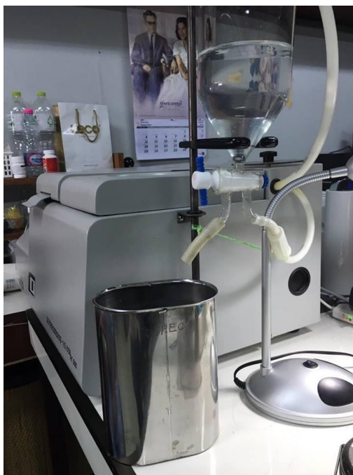
ภาพที่ จ-5 การติดตั้งอุปกรณ์การตรวจวัดค่าความร้อนของเชื้อเพลิงชีวภาพไมโครอิมัลชัน
