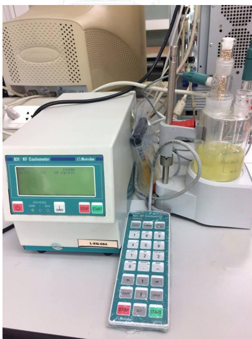
ภาพที่ จ-6 การติดตั้งอุปกรณ์การตรวจวัดปริมาณน้ำของเชื้อเพลิงชีวภาพไมโครอิมัลชัน
