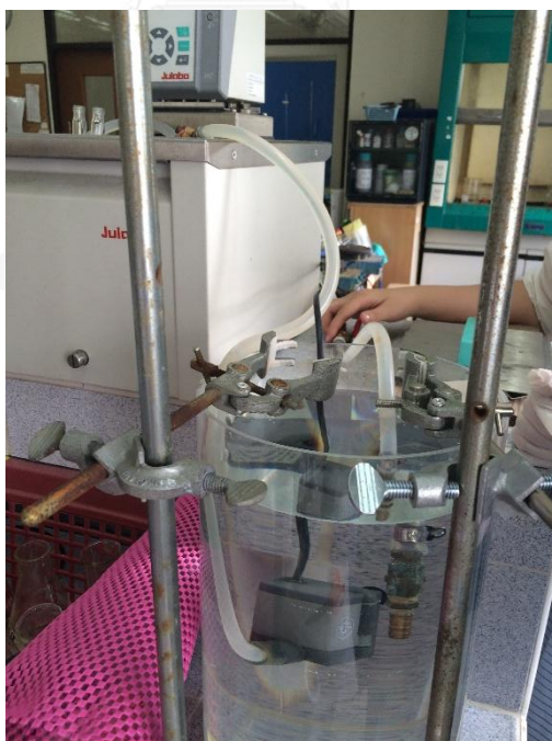
ภาพที่ จ-2 การติดตั้งอุปกรณ์ในการวัดความหนืดเชิงจลนศาสตร์ตามมาตรฐาน ASTM D445
