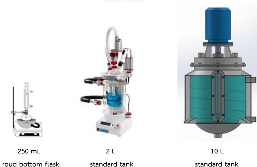
รูปที่ 14 แผนภาพการขยายขนาดการสังเคราะห์ไซโคลเดกซ์ทรินเชื่อมโคโตซาน [21]
