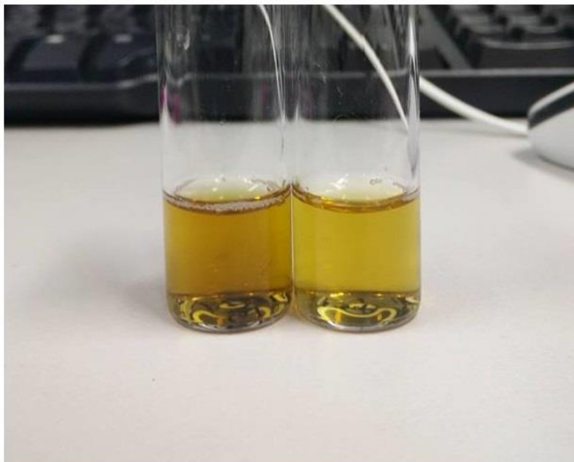
รูปที่ 26 ตัวอย่างสารละลายควอเทอร์ไนซ์ไฮโคลเดกซ์ทรินเชื่อมโคโตซานความเข้มข้น 5 มิลลิกรัมต่อมิลลิลิตร (ซ้าย) และ 10 มิลลิกรัมต่อมิลลิลิตร (ขวา) ที่ใช้ในการวัดค่าการส่องผ่านของรังสี
