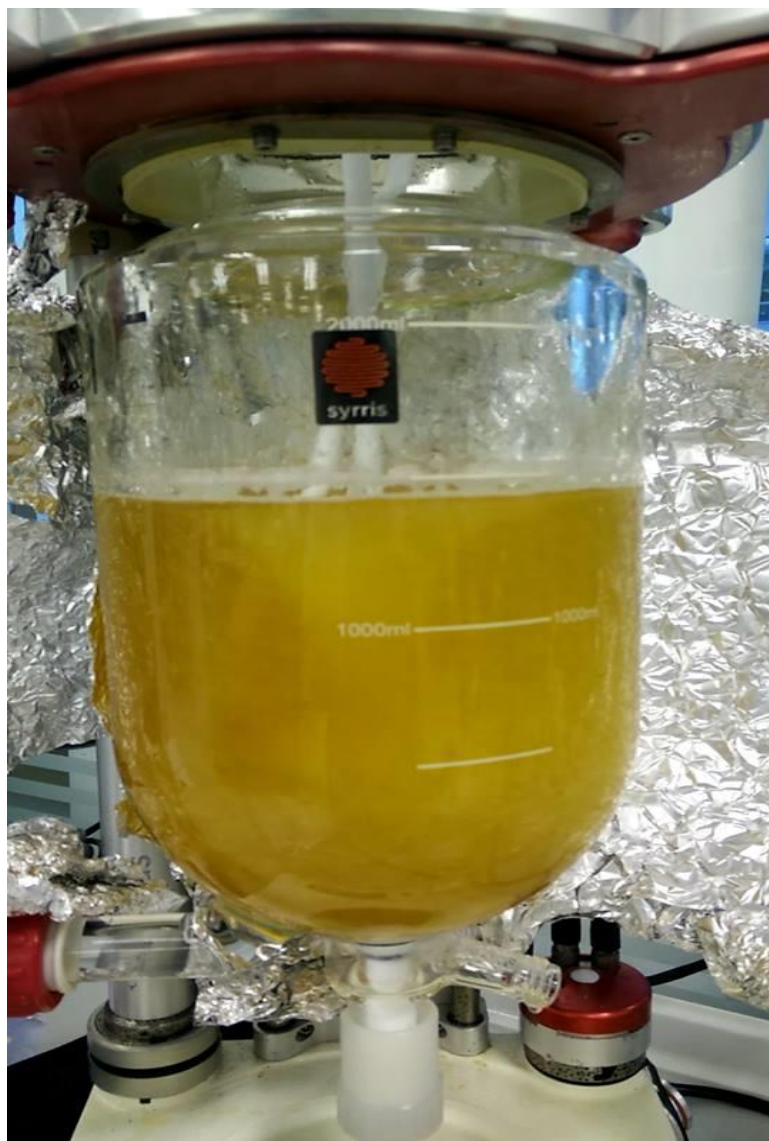
รูปที่ 33 vortex และฟองอากาศที่เกิดขึ้นในการปั่นกวนที่ความเร็วรอบในการปั่นกวนเท่ากับ 600 รอบต่อนาที
